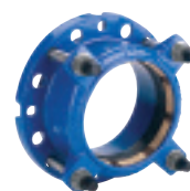
Серия 623/10 Фланцевый адаптер Supa Plus™ Фиксирующего типа для ПЭ и НПВХ труб. Универсальная рассверловка Высокопрочный чугун DN40-300 PN10/16
