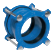
Серия 601 Прямая муфта Supa® Фиксирующего типа для труб из НПВХ, АЦ, стали и чугуна Высокопрочный чугун DN40-400 PN16
