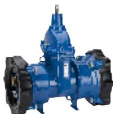
Серия 636 Supa Maxi™ Задвижка клиновья с муфтами Фиксирующего типа, для всех видов труб. Высокопрочный чугун DN80-200 PN16
