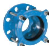
Серия 603 Фланцевый адаптер Supa® Фиксирующего типа для труб из НПВХ, АЦ, стали и чугуна Универсальная рассверловка Высокопрочный чугун DN40-400 PN10/16
