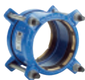
Серия 621/10 Прямая муфта Supa Plus™ Фиксирующего типа для ПЭ и НПВХ труб. Высокопрочный чугун DN32-300 PN16
