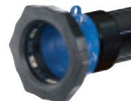
Серия 635 Переходная муфта Supa Maxi™ с ПЭ патрубком PN10 или PN16. Фиксирующего типа для всех видов труб. Высокопрочный чугун DN50-300 PN10/16
